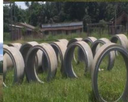
**PROYECTO: PROVISION Y TRANSPORTE DE ALCANTARILLAS TIPO TUBO DE H°A° DE 1 M DE DIAMETRO PARA LA CENTRAL CASCABEL
